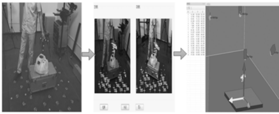
图 7 点阵式探针系统组成及测量过程
