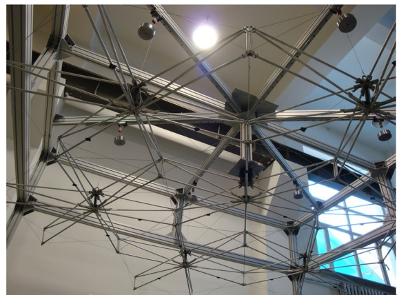
图 14 形面精度测量试验布置
