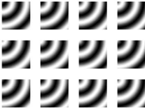
图 3 可调谐激光器光强变化下的 12 副干涉图
