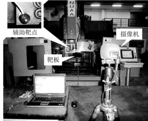
图 6 靶点位置关系标定现场图
