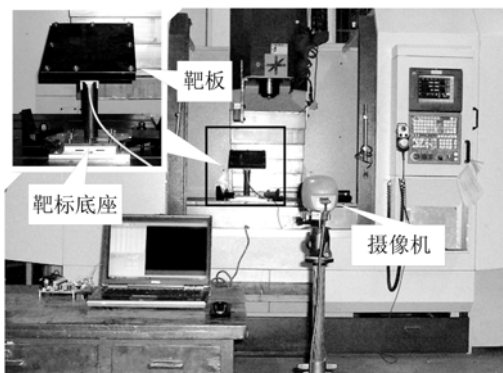
图 7 “靶/座”标定现场图
