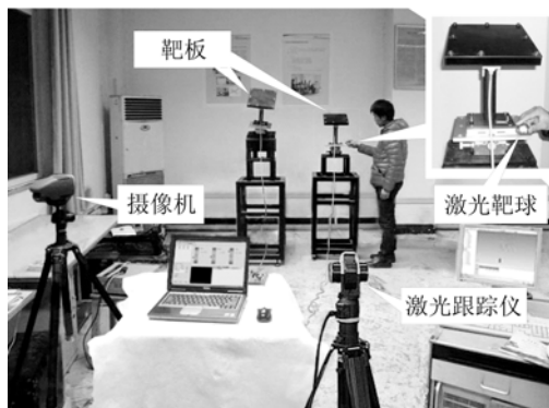
(b) 与激光跟踪仪姿态测量对比实验现场图
