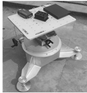
图 2 偏振光测试装置 Fig. 2 Polarization test system
