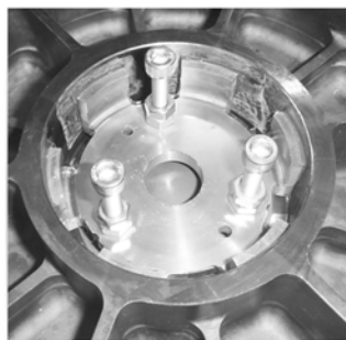
图 19 改进设计后的镶嵌件与反射镜黏胶
