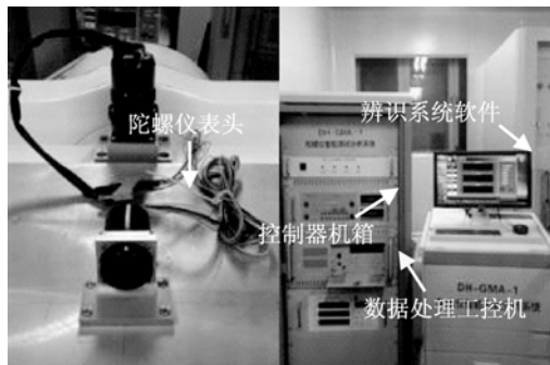
图 5 动力调谐陀螺仪闭环辨识实验系统
