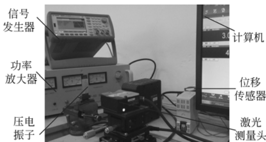
图 7 压电振子端部位移幅值 X 测试系统图
