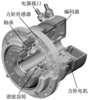
图 1 模块化谐波传动组件 Fig. 1 Harmonic drive module
