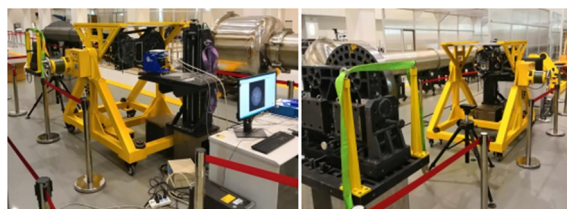
图 15 失重环境适应性试验
