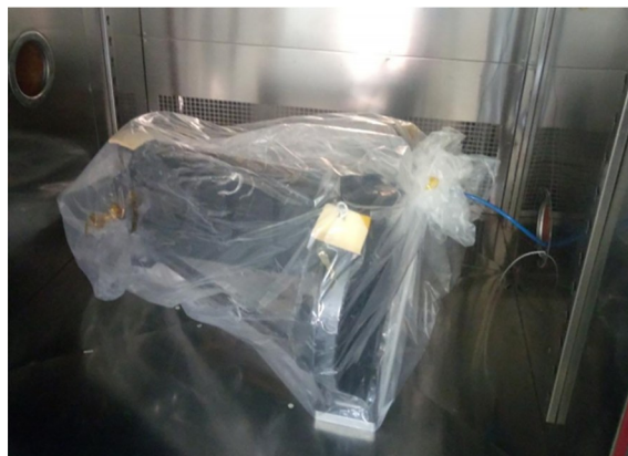
图 14 主光机结构高低温循环试验环境
