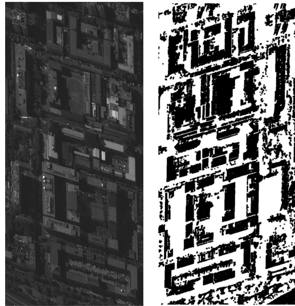
(a) 原始图像 (a) Original image (b) 阴影检测效果图 (b) Shadow image
