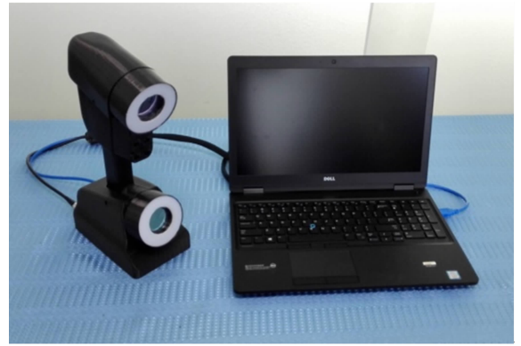
图 4 手持式三维激光扫描设备
