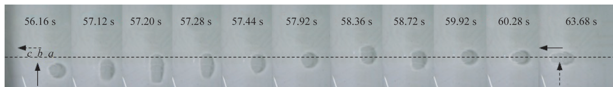
图 12 液滴变道过程示意图
