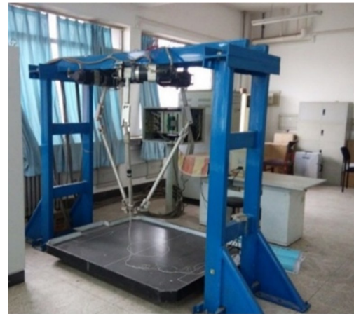
图 1 3-RRRU 并联机器人 Fig. 1 3-RRRU parallel robot
